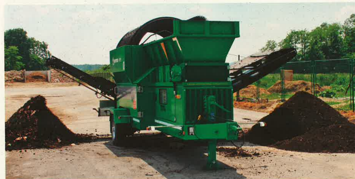
Joker mobilno roto sito postavljeno je na prikolicu s jednom osovinom. Ukupna masa stroja je pet tona. U transportnoj konfiguraciji dimenzije mu iznose 7,65 x 2,55 x 3,83 m. Kapacitet prosijavanja je 35 m 3 /h
